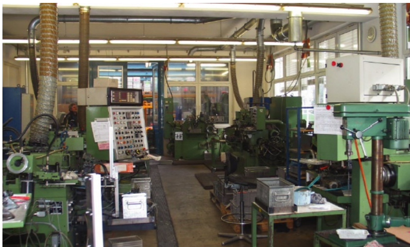
Önebelabscheider in einer Präzisionsdreherei. Insgesamt werden 35 Bearbeitungszentren abgesaugt. Der Önebelabscheider ist zentral im Außenbereich installiert.
