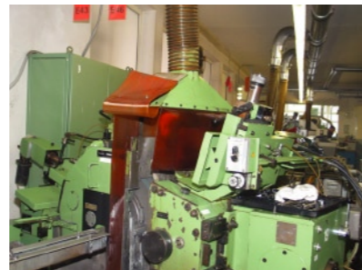
Emulsionsnebel erfassung an einer nicht gekapselten Bearbeitungsmaschine
